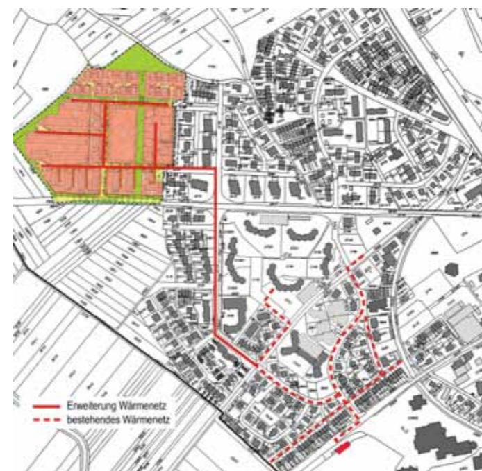
Abbildung 72: Neubaugebiet mit bestehendem und geplantem Wärmenetz
