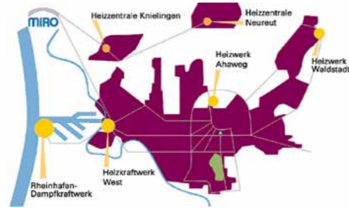
Abbildung 45: Fernwärmenetz von Karlsruhe
