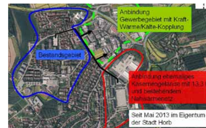
Abbildung 43: Erweiterung des Wärmenetzes Hohenberg
