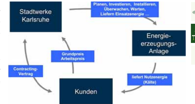
Abbildung 48: Kältelieferung im Contracting
