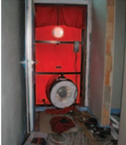
Abb. 39: Vorbereitung eines Luftdichtheits-tests an einer Außentür
