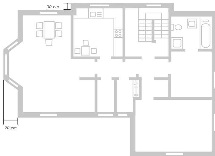
Abb. 20: Beispielgrundriss Erdgeschoss mit Vor- und Rücksprüngen unterschiedlicher Abmessungen
